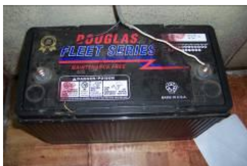
Fotografía 001.5 Batería de 130 A
